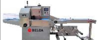
Flow-pack horizontal con sincronismo de tres motores de tamaño compacto con doble portabobinas. Con circulación suave y sin presión para productos inestables.
