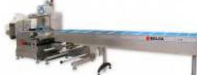
Flow-pack horizontal inoxidable con doble portabobinas. Con circulación suave del producto y sin presión. Transportador de entrada mediante banda con control de separación.
