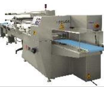
Flow-pack inoxidable horizontal con sincronismo de tres motores. Entrada con posicionamiento sincronizado multibanda y doble portabobinas con opción de cambio automático.
