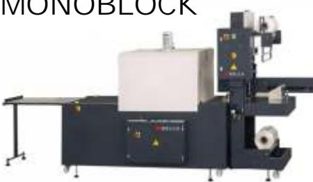
La BES MONOBLOCK es una enfajadora semiautomática muy versátil con introducción y soldadura neumáticas. La colocación del producto frente al empujador es manual y la salida se realiza a una mesa montada sobre la entrada del túnel de retracción.
