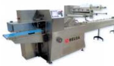
Máquina horizontal flow-pack dotada de tres motores independientes sincronizados mediante control multi-ejes. Fabricada en acero inoxidable. Con doble portabobinas y opción de cambio automático.
