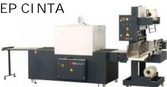
Enfajadora con entrada perpendicular mediante banda motorizada y automatismo de introducción. Puede ser usada como semiautomática o como plenamente automática. La cadencia máxima es, en función de las características del paquete, en torno a unas 20 introducciones por minuto.
