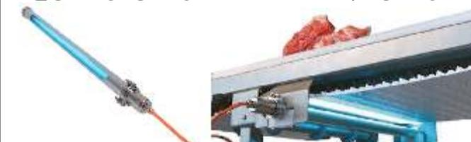
Sistema para la prevención de la contaminación cruzada y desinfección en las bandas. Las lámparas usadas en el módulo ofrecen cuatro veces mayor potencia de emisión por unidad de longitud que las lámparas UV convencionales, más eficiente que las lámparas cilíndricas convencionales lo que supone un ahorro en repuestos y energía.
