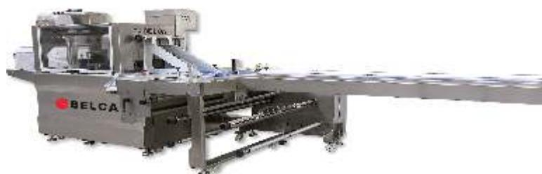
Flow-pack inoxidable diseñada para el embolsado de productos alimenticios con mordaza COMBI que le permite trabajar con films BOPP, films complejos termosellables y films retráctiles sin efectuar modificaciones mecánicas. Con corte del sobrante longitudinal y recogedor de fácil acceso.
