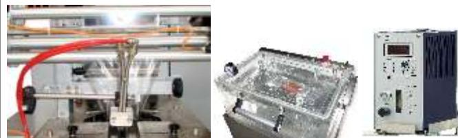
Las unidades con cierre estanco pueden incorporar sistemas de inyección de gas inerte con análisis continuo para formar una atmósfera protectora en el interior del paquete. Además de éstos, disponemos de sistemas separados para el control de fugas adecuados a este tipo de producción.
