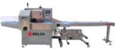
Flow-pack horizontal con sincronismo de tres motores de tamaño compacto con doble portabobinas. Con circulación suave y sin presión y entrada combinada de empujadores y banda.
