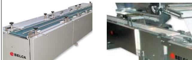
Los sistemas de sincronización de carga en línea aseguran la separación entre productos modificando la velocidad de diversos tramos para modificar la separación entre productos o detener el cabezal para esperar la llegada de ellos, incrementando muy considerablemente el volumen de producción ya que ésta deja de depender de la pericia de carga del operario.
