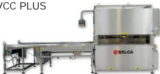
Unidad de vacío para líneas de envasado flow-wrap de productos frescos. Puede trabajar en modo activado como línea de vacío o como línea de transporte cuando no es necesario el vacío.
