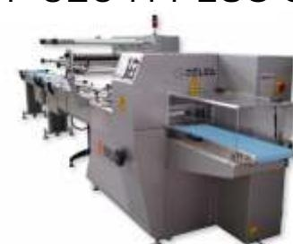
Flow-pack basada en la BF 325 H PLUS pero que integra un sistema de sincronismo de alimentación de alto rendimiento mediante un sistema de bandas que posicionan el producto mientras circula por la entrada.
