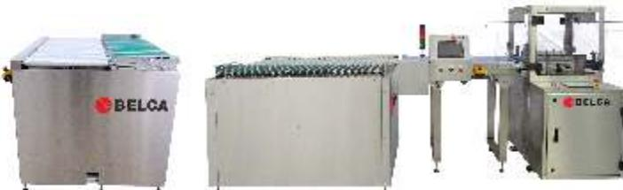
El módulo de cambio de vías es un KIT utilizado a la salida de una envolvedora para efectuar un cambio de sentido en 90 grados de un producto.
