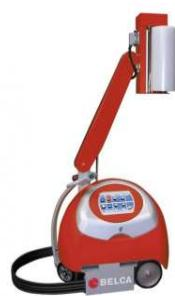
Robot de enfardado con embrague mecánico para el control de la tensión del film, móvil y semiautomático, que funciona con el auxilio del operador para la colocación frente al palet y el atado del extremo de film.
