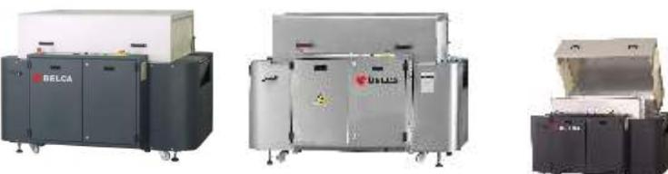
Túnel construido en acero inoxidable o acero pintado con sistema de transporte por medio de rodillos móviles recubiertos de silicona. Dispone de un sistema de apertura de capota superior lo que permite un fácil ajuste de los caudales interiores de aire y una rápida limpieza.
