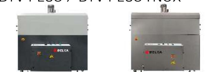
Túnel construido en acero inoxidable o acero pintado con sistema de transporte por medio de rodillos móviles recubiertos de silicona. Dispone de un sistema de ajuste de los caudales interiores de aire desde el exterior.
