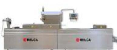
Termoformadora para envasado automático de todo tipo de productos, tanto con film flexible como semirígido y opcionalmente atmósfera modificada.
