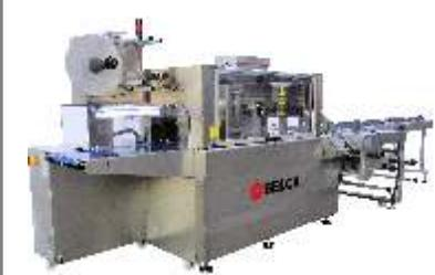
Flow-pack inoxidable para el envasado en segunda piel de productos alimenticios secos y/o húmedos. Con entrada motorizada mediante banda modular.
