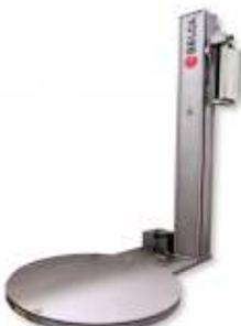
Enfardadora de acero inoxidable de funcionamiento automático, únicamente requiere que el operario ate el extremo del film en el palet. Posibilidad de instalar una rampa de acceso para transpaletas manuales.
