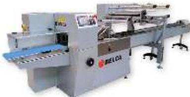
Envolvedora horizontal flow-pack con sincronismo de tres motores. Para envasado de productos anchos. Con doble portabobinas con opción de cambio automático y entrada mediante empujadores.
