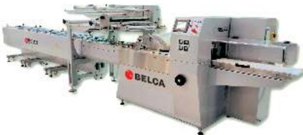
Flow-pack de gama alta con cambio automático de bobina. Incorpora control electrónico multi-ejes para sincronizar todos los movimientos y permitir rápidos cambios de formato y muy alto rendimiento. Sistema de 5 bandas controlado por variadores electrónicos y PLC que regulan de forma progresiva la distancia entre las piezas de manera que el sincronismo se realiza a muy elevada velocidad y parando únicamente cuando hay ausencia de producto.
