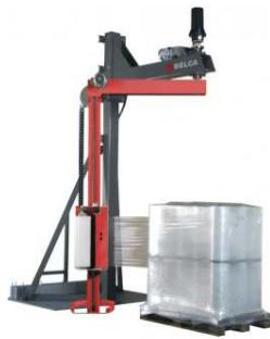
Enfardadora automática con movimiento de envoltura de la bobina sobre el palet. En esta envolvedora es la bobina la que gira alrededor del palet de manera que no se desmonte por el giro.
