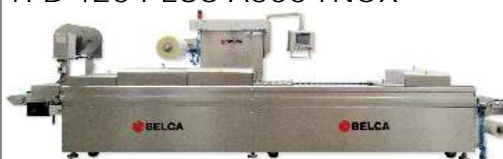
La TFB 420 PLUS es una máquina termoformadora para el envasado al vacío en film flexible orientada a producto fresco y congelado. Construcción en acero inoxidable con elementos en aluminio anodizado. Construcción robusta, con movimientos servomotorizados en cadena de avance y grupos de elevación para control de posicionamiento y alcanzar un rendimiento óptimo de ciclos de producción. Permite trabajar con film flexible desde 60 hasta 300 mc.
