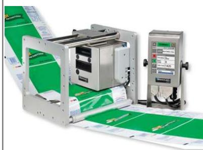
Sistemas de marcaje e impresión para montaje en flow-pack y máquinas de ciclo continuo. Marcaje directo sobre el film de envoltura.
